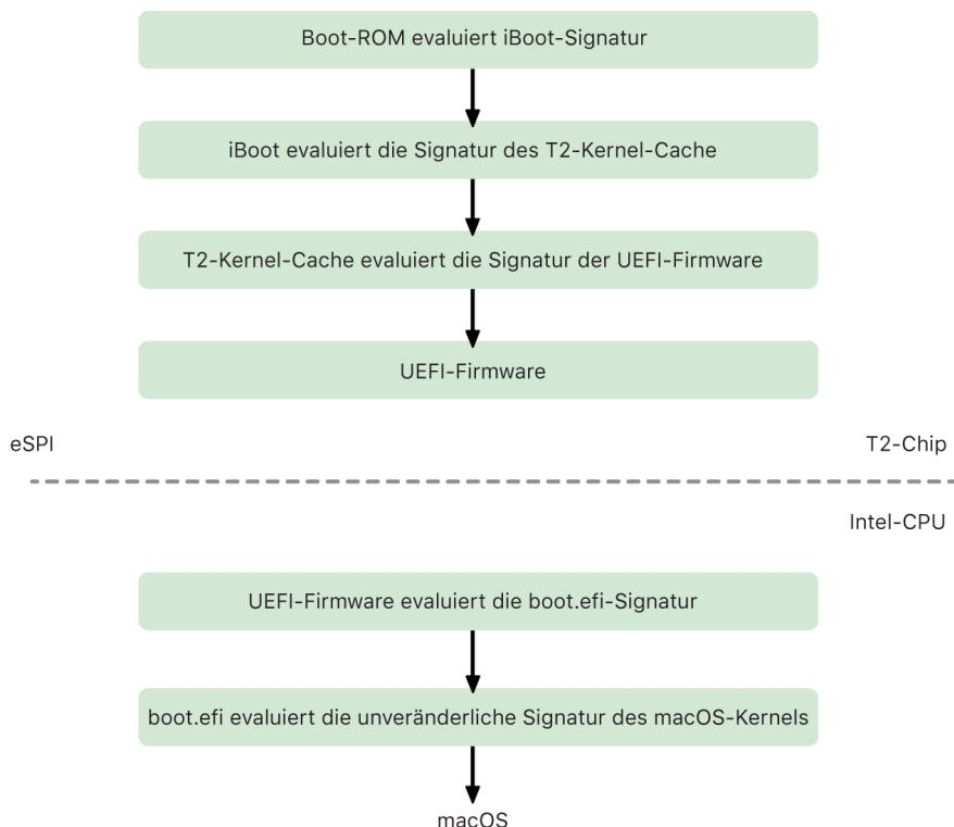
Nach der Überprüfung wird das UEFI-Firmware-Image in einem Teil des T2-Chip-Speichers abgebildet. Dieser Speicher wird der Intel-CPU über das eSPI (enhanced Serial Peripheral Interface) zur Verfügung gestellt. Wenn die Intel-CPU erstmals gestartet wird, ruft sie die UEFI-Firmware über das eSPI von der auf Integrität geprüften und im Speicher abgebildeten Kopie der Firmware ab, die sich auf dem T2-Chip befindet.
