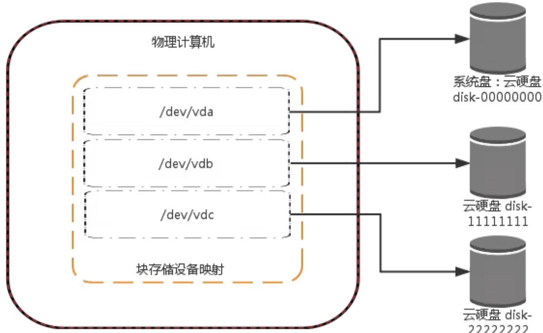
此图显示了 CBS 如何将块存储设备映射到云服务器上：将 `/dev/vda` 映射到系统盘上，并将两块数据盘分别映射到 `/dev/vdb` 和 `/dev/vdc`。
